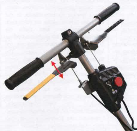
Abbildung 16: Kupplungshebel für Radantrieb auf der rechten Seite
